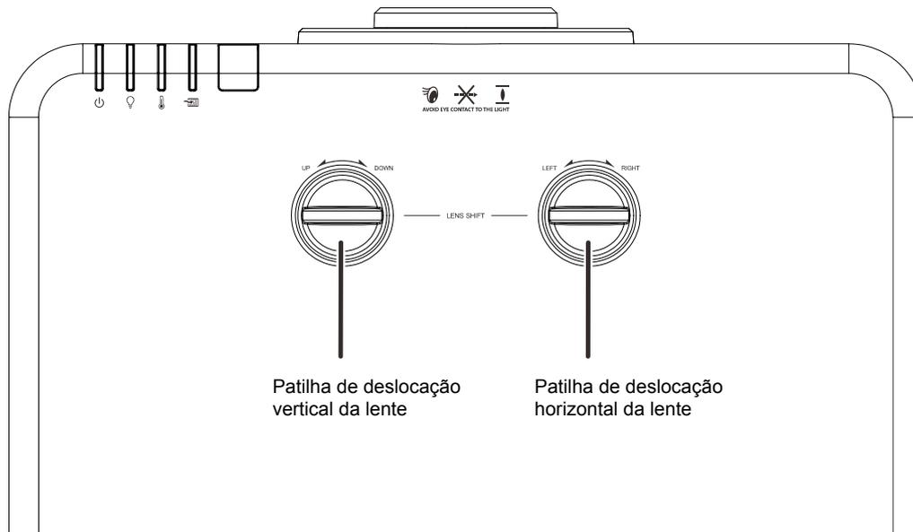
A funcionalidade de Deslocação da lente permite o ajustamento da posição da imagem projectada, horizontal ou verticalmente, nos intervalos detalhados abaixo.
