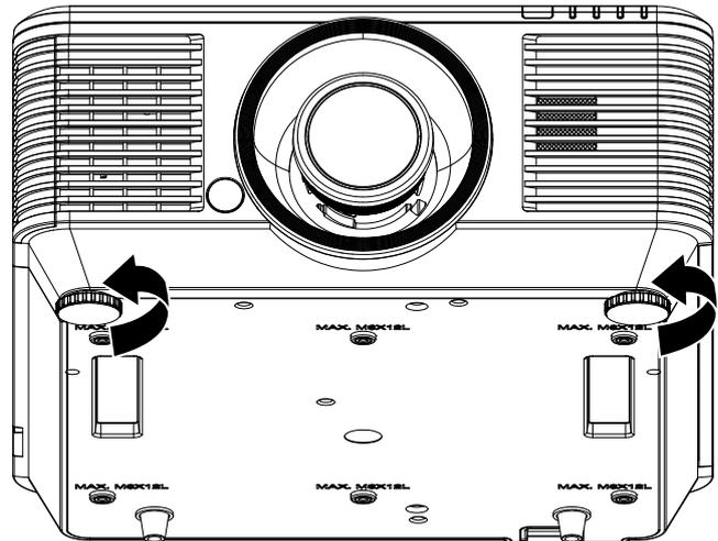
2. Para baixar o projector, levante-o e rode os parafusos de ajuste no sentido dos ponteiros do relógio.
